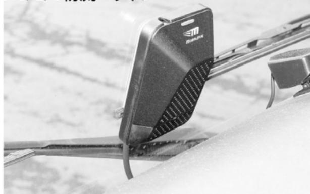
モバイルアイは、車線や歩行者、前方車両などの障害物を画像認識するフロントガラスに取り付ける単眼カメラと、ダッシュボード上のモニター装置で構成。簡単に後付けで装着のフロントガラスに装着したモバイルアイ
